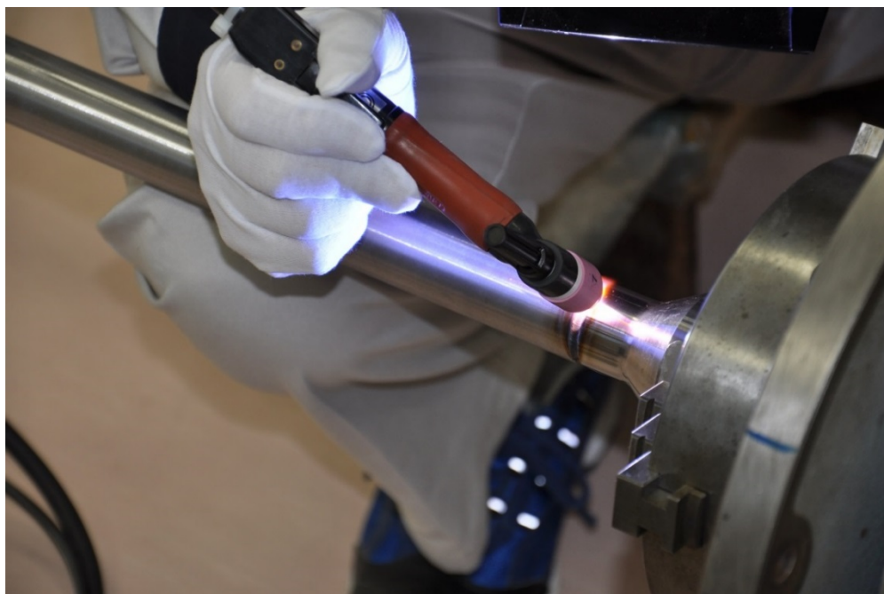
図IV-5-2 照射脆化評価用キャプセルのレジューサ部改造作業
