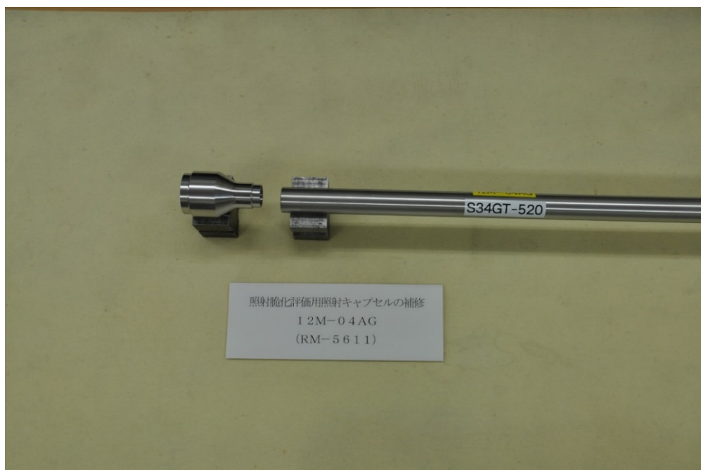
図IV-5-1 照射脆化評価用キャプセルのレジューサ部
