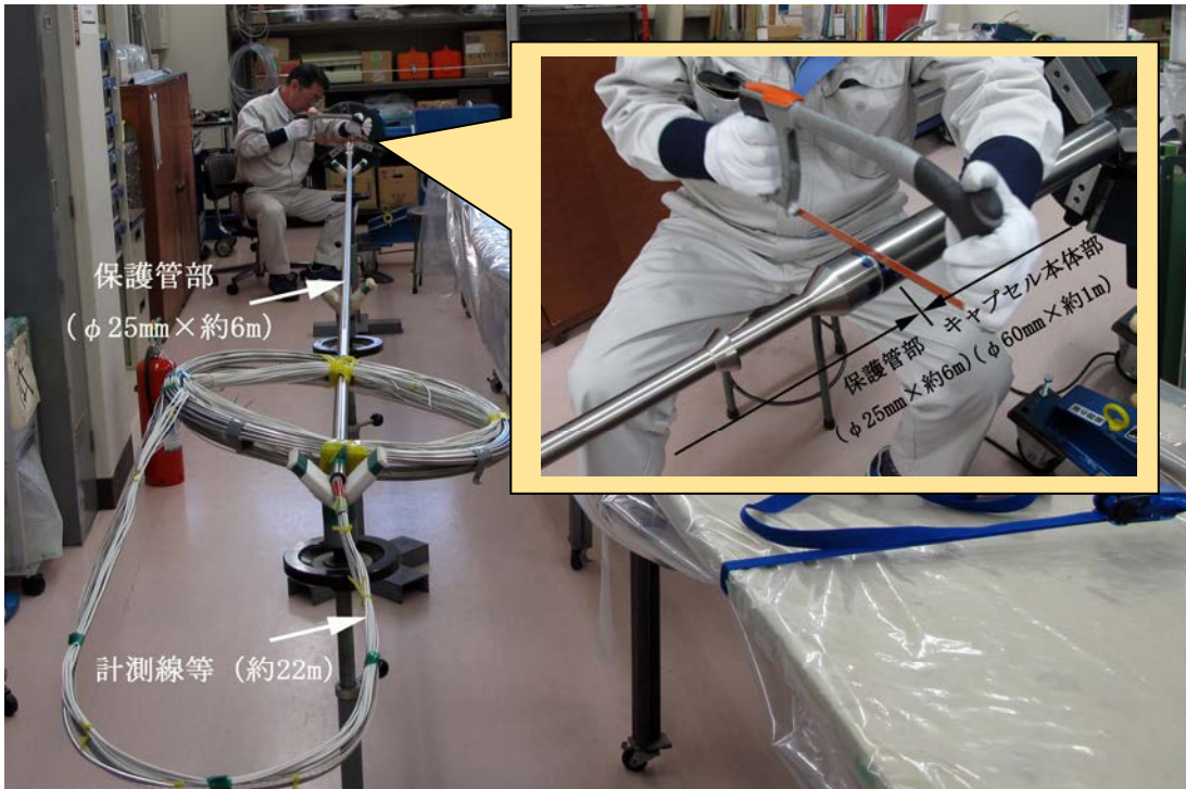
図IV-5-6 中性子束及びガンマ線調整型照射キャプセルの保護管部切り離し作業
